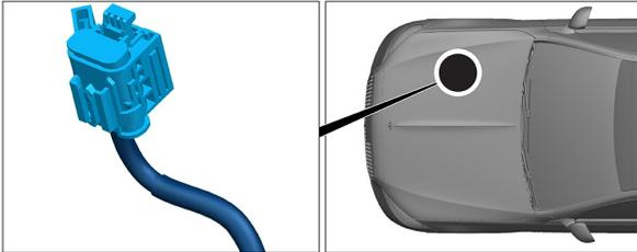
Le dispositif de coupure haute tension se trouve dans le compartiment moteur, côté conducteur.
