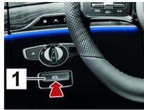
Appuyer sur le bouton P sur le levier de vitesses (1). Le frein de parking est automatiquement activé. Frein de stationnement électrique (1)
