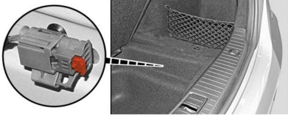
Sous le recouvrement du logement dans le coffre, à droite à l'arrière, se trouve le dispositif de coupure haute tension. Le revêtement du logement doit être retiré du coffre en tirant sur la languette située sous le seuil de chargement, au milieu du véhicule.
