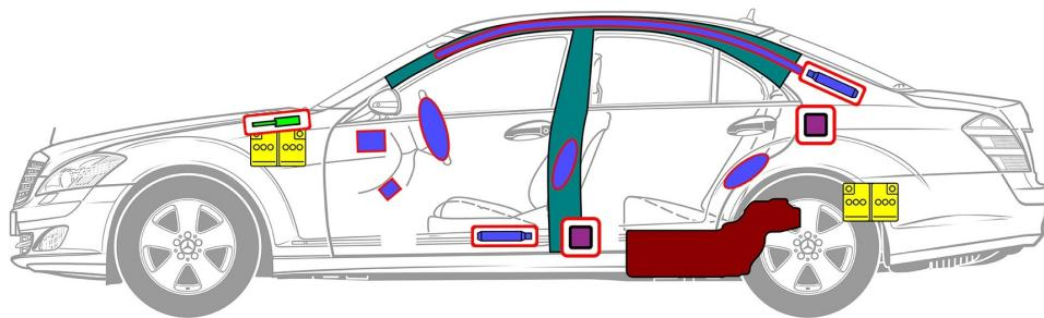
① Batterie compartiment moteur, direction à gauche
