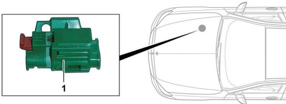
Le sectionneur haute tension se trouve dans le compartiment moteur du côté passager avant.
