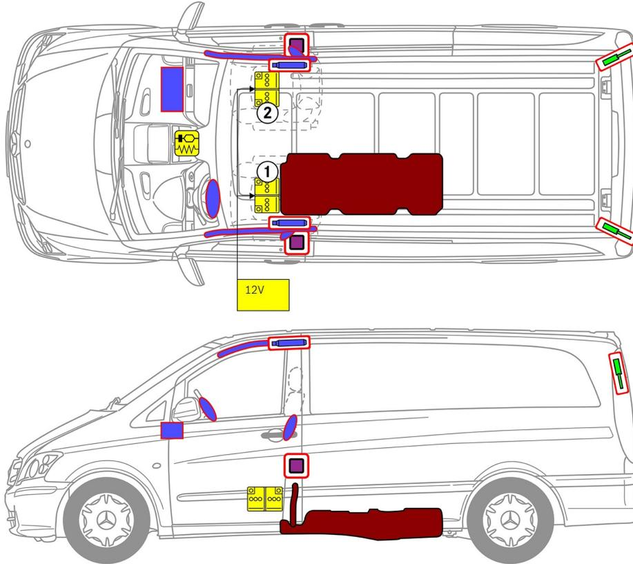
① Batterie de démarrage (Direction à gauche) ou Batterie additionnelle (Direction à droite)
