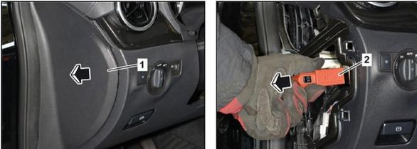
Le dispositif de coupure haute tension se trouve derrière l'habillage latéral du tableau de bord, à gauche dans le sens du déplacement.
