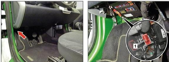
El dispositivo de desconexión de alto voltaje se encuentra en la parte inferior del tablero de instrumentos en el sentido de marcha, izquierda.
