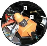
El dispositivo de desconexión de alto voltaje se encuentra en la parte superior en el compresor de agente frigorígeno (3) en el vano motor en el sentido de marcha izquierdo.
