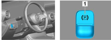
Pulsar el interruptor P de la palanca de cambio (1). El freno de estacionamiento se activa automáticamente.
