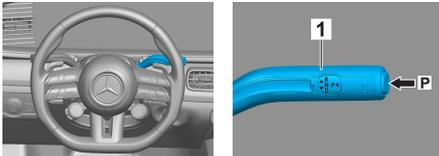
Pulsar el interruptor P de la palanca de cambio (1). El freno de estacionamiento se activa automáticamente.
