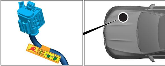
El dispositivo de desconexión del alto voltaje se encuentra en el compartimento del motor, en el lado del acompañante.
