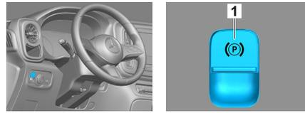
Poner la palanca de cambio (1) en la posición P. El freno de estacionamiento se activará automáticamente.
