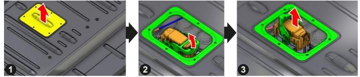
El dispositivo de desconexión de alto voltaje se encuentra en el compartimento del motor del lado del conductor.
