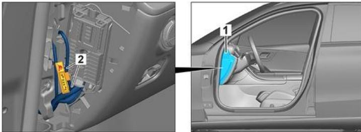
Retirar la cubierta (1). Cortar el cable en la posición marcada (2).
