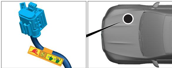
El dispositivo de desconexión del alto voltaje se encuentra en el compartimento del motor en el sentido de la marcha a la derecha.
