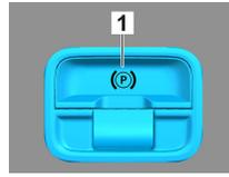
Pulsar el interruptor P de la palanca de cambio (1). El freno de estacionamiento se activa automáticamente.
