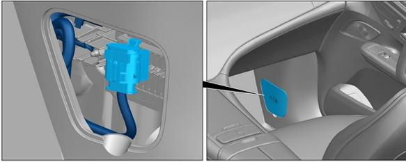
El dispositivo de desconexión del alto voltaje se encuentra en la parte inferior, en el montante A del lado del acompañante.
