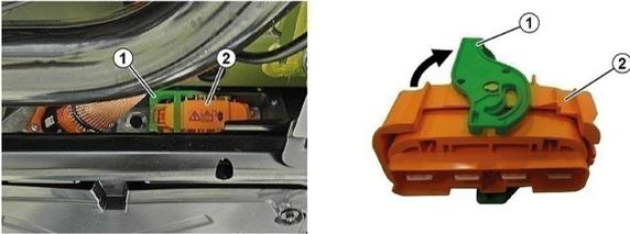
El dispositivo de desconexión de alto voltaje se encuentra en la parte inferior de la batería de alto voltaje en el sentido de marcha detrás, derecha.
