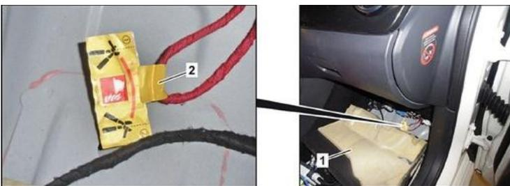
Abatir el revestimiento del espacio reposapiés (1) hacia atrás /cortar el cable en la posición marcada (2)
