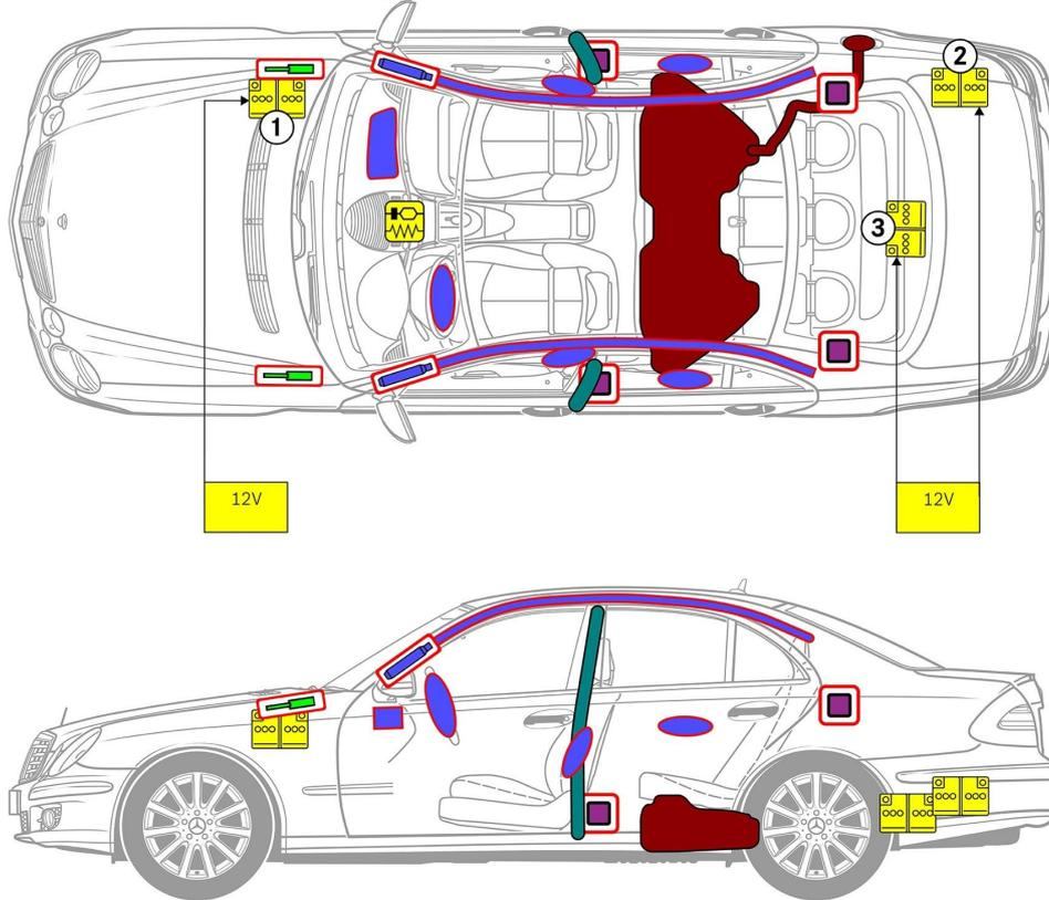
① Batería adicional vano motor (hasta 31.05.2006)
