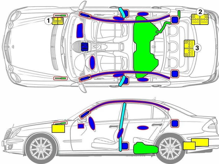
① Batería adicional vano motor (hasta 31.05.2006)
