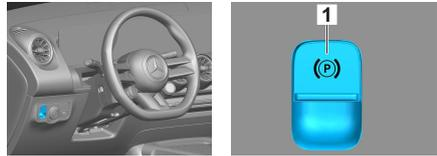
Schalter P am Wählhebel (1) drücken. Die Parkbremse wird automatisch aktiviert.
