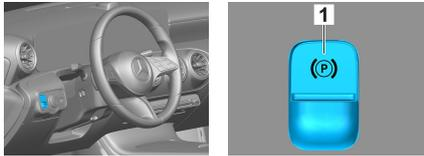
Schalter P am Wählhebel (1) drücken. Die Parkbremse wird automatisch aktiviert.
