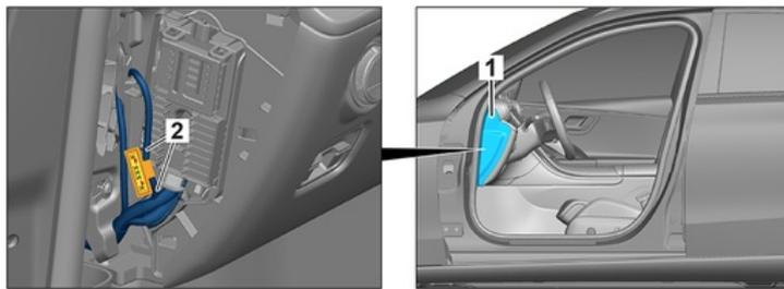
Abdeckung (1) entfernen. Leitung an der markierten Stelle (2) durchschneiden.
