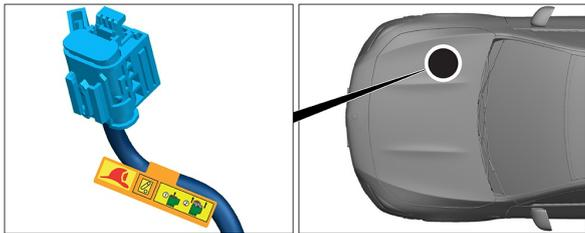
Die Hochvolt-Abschaltvorrichtung befindet sich im Motorraum in Fahrtrichtung rechts.
