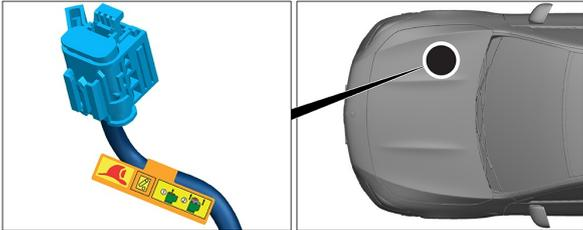
Die Hochvolt-Abschaltvorrichtung befindet sich im Motorraum in Fahrtrichtung rechts.
