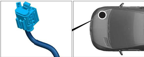
Die Hochvolt-Abschaltvorrichtung befindet sich im Motorraum auf der Beifahrerseite.
