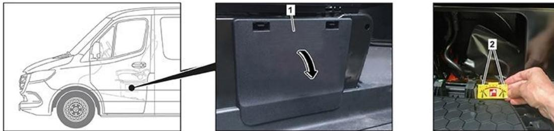
Abdeckung (1) entfernen. Leitung an der markierten Stelle (2) durchschneiden.
