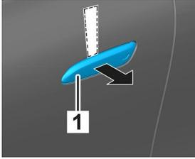
Einen flachen, nicht metallischen Gegenstand von oben hinter den eingefahrenen Türgriff (1) schieben und ihn leicht nach außen hebeln.
