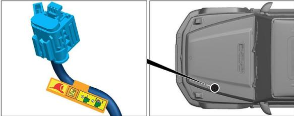
Die Hochvolt-Abschaltvorrichtung befindet sich im Motorraum auf der Fahrerseite.
