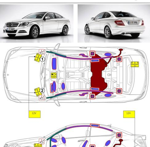
1 Bordnetzbatterie, Linkslenker 2 Bordnetzbatterie, Rechtslenker
