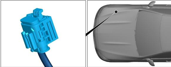
Die Hochvolt-Abschaltvorrichtung befindet sich im Motorraum auf der Beifahrerseite.
