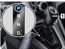
Wählhebel (1) in Stellung P drücken. Die Parkbremse wird automatisch aktiviert.
