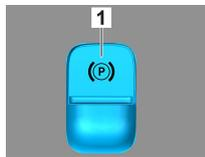
1. Elektrische Feststellbremse
