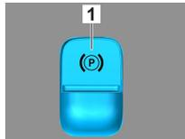
1. Elektrische Feststellbremse
