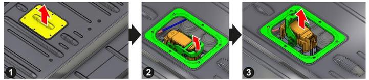
Die hintere Sitzbank nach vorne schieben und anheben. Die Hochvolt-Abschaltvorrichtung befindet sich im Innenraum an der Oberseite der Hochvoltbatterie.
