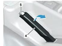
1. Elektrische Feststellbremse
