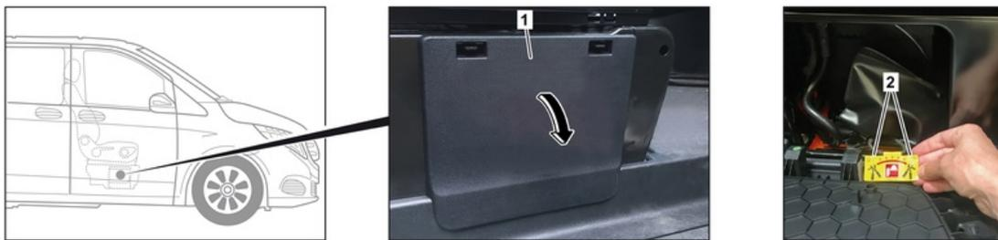
Abdeckung (1) entfernen. Leitung an der markierten Stelle (2) durchschneiden.
