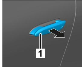
Von unten hinter den Türgriff (1) greifen und bis zum Widerstand nach außen ziehen und halten.
