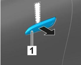
Einen flachen, nicht metallischen Gegenstand von oben hinter den eingefahrenen Türgriff (1) schieben und ihn leicht nach außen hebeln.
