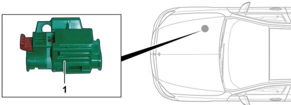
Die Hochvolt-Abschaltvorrichtung befindet sich im Motorraum auf der Beifahrerseite.
