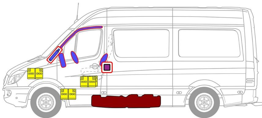
① Starterbatterie (Linkslenker, Rechtslenker)
