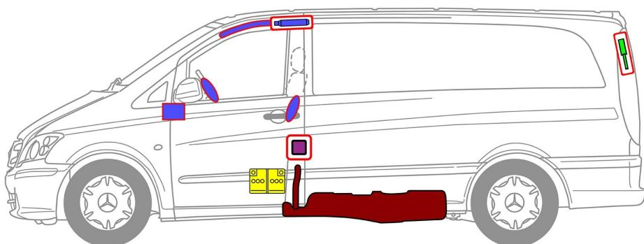
① Starterbatterie (Linkslenker) oder Zusatzbatterie (Rechtslenker)
