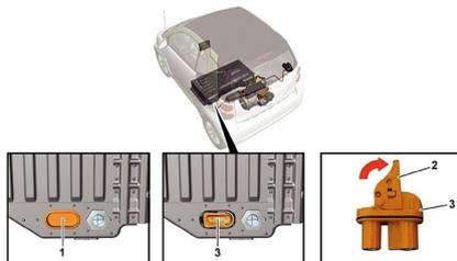
Die Hochvoltabschaltvorrichtung befindet sich an der Unterseite der Hochvoltbatterie in Fahrtrichtung hinten links.
