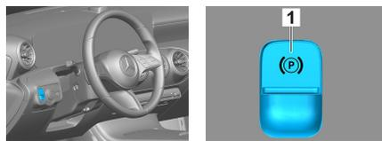
Натиснете превключвателя P на превключвателния лост (1). Спирачката за паркиране се активира автоматично.
