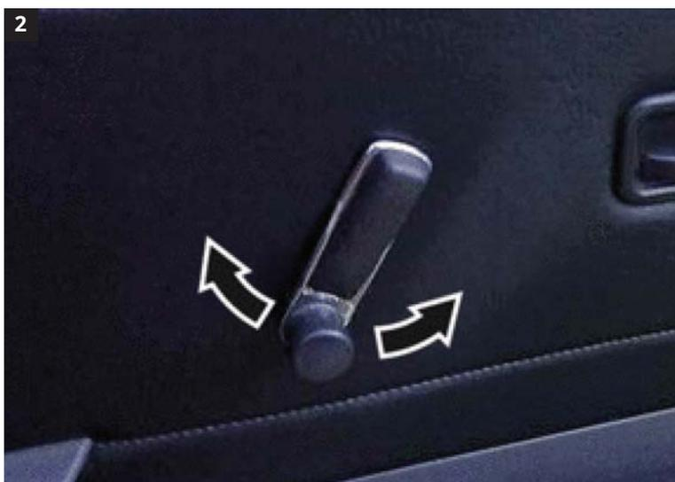
Въртящо се лостче на ръчния механизъм на стъклото
