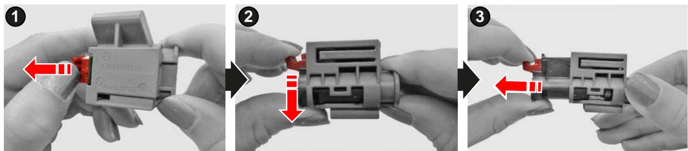
Задействане на съоръжението за изключване на високото напрежение (1):
