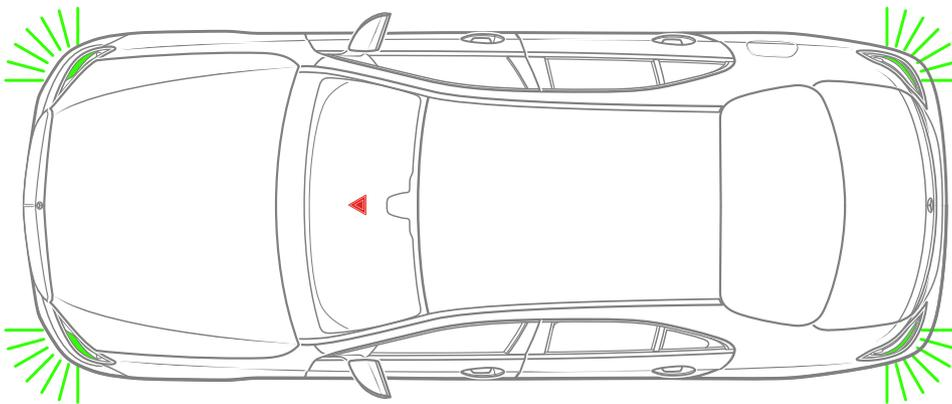
След задействане на минимум една от системите за пасивна безопасност при по-новите модели на Mercedes-Benz, Mercedes-AMG, Mercedes-Maybach и smart автоматично могат да се включат аварийните светлини, ако захранването с напрежение в автомобила е активно. Освен за осигуряване на автомобила, това служи и за индикация на активното захранване с напрежение. При спасителните мерки собствената безопасност е на първо място.
