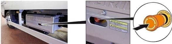
Аварийный выключатель находится в выемке боковой облицовки высоковольтной аккумуляторной батареи.
