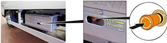
緊急關閉按鈕位於高電壓電瓶側飾板凹槽。
