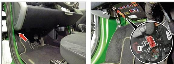
Naprava za izklop visokonapetostnega sistema je nameščena na spodnji strani armaturne plošče v smeri vožnje levo.
