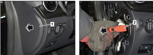
Die Hochvoltabschaltvorrichtung befindet sich in Fahrtrichtung links hinter der Seitenverkleidung der Instrumententafel.
