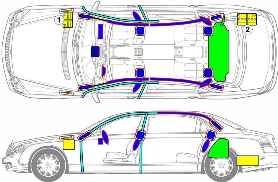
① 엔진실 스타터 배터리      ② 트렁크 차량 전원 배터리
